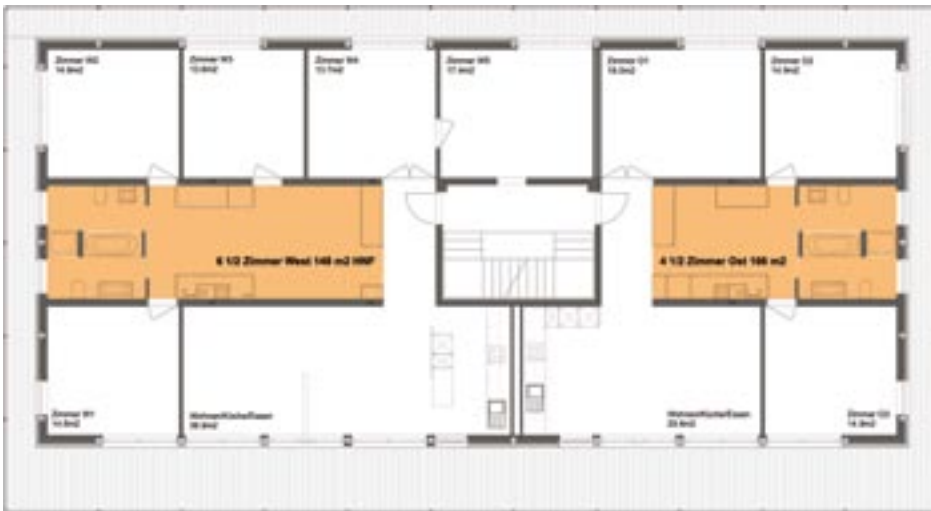
Stockwerkgrundriss mit 6½- und 4½-Zimmer-Wohnung. Die Zimmer sind um einen tragenden Kern angeordnet. Orange eingezeichnet der Kernraum und die beiden Badezimmer. Sie sind ineinander verschrankt: Das eine bietet eine Badewanne, das andere eine Dusche.
